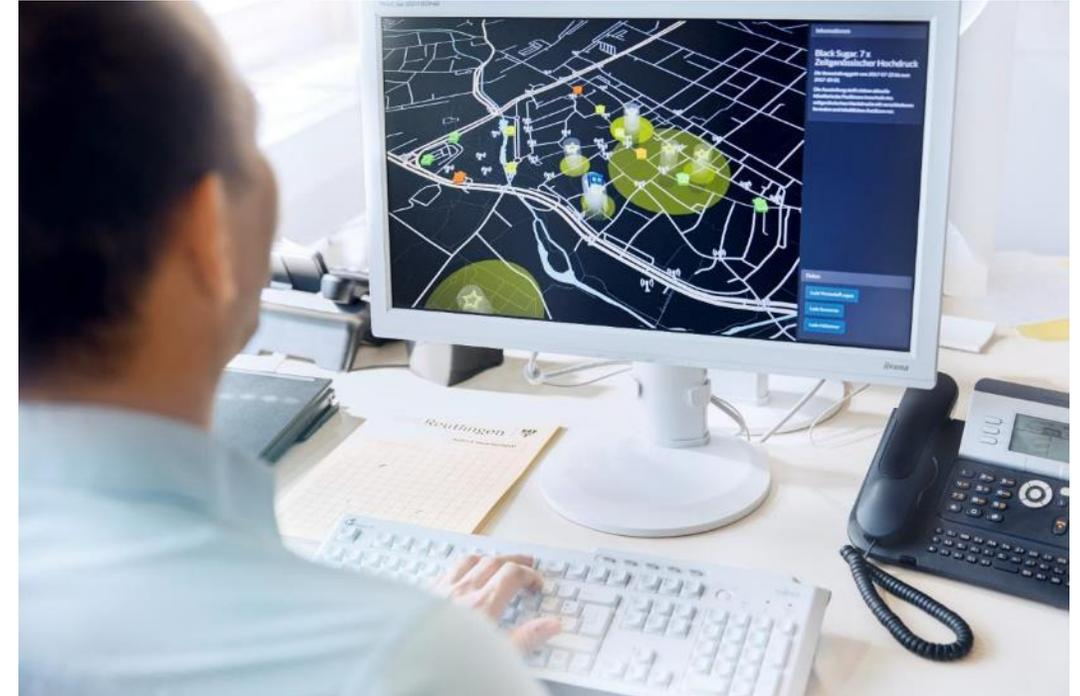
Auf Basis von **Füllstands- und Bewegungsdaten** sowie prognostizierter Füllgeschwindigkeit werden **Routen zur Müllentleerung** bedarfsgerecht geplant. Es kann zudem zwischen vollen und verstopften Müllbehältern unterschieden werden. Die Entsorgung und Stadtreinigung kann durch **Vernetzung der Akteure** verbessert werden. Unter anderem Veranstaltungsdaten werden eingebunden.
