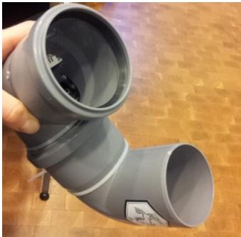
Der 30-Euro-Feinstaubsensor vom OK-Lab Stuttgart. Informationen unter Luftdaten.info
